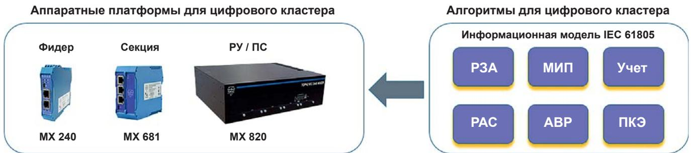
Рис. 3. Структурная схема цифрового кластера на базе TOPAZ iSAS®
