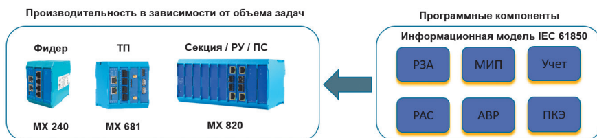
Рис. 5. Индустриальная серверная платформа TOPAZ IEC DAS + алгоритмы защиты и управления = ПТК TOPAZ iSAS
