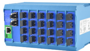
Рис. 8. Управляемый сетевой коммутатор TOPAZ SW5xx с поддержкой PTPv2
