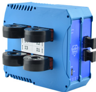
Рис. 7. Устройство сопряжения аналоговых сигналов с цифровой шиной процесса TOPAZ AMU
