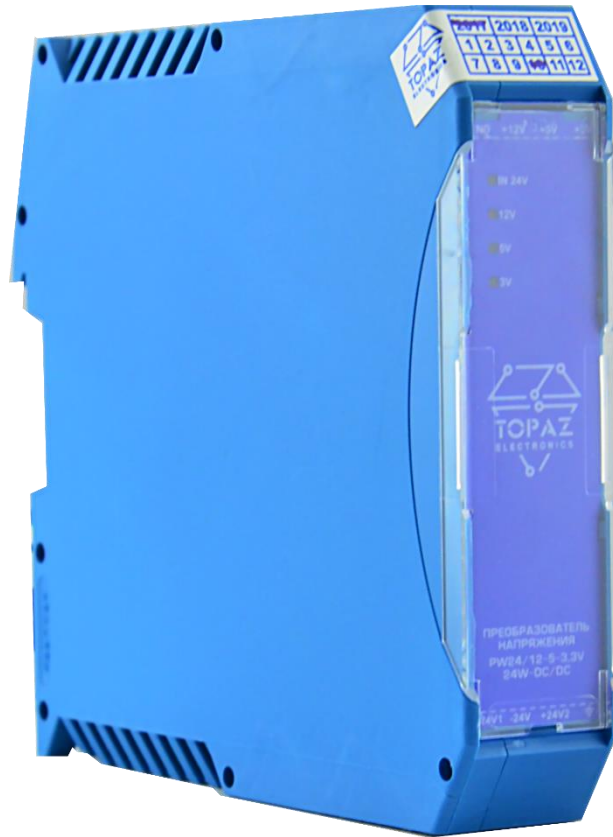
Рисунок А.1 – Внешний вид преобразователя TOPAZ PW24/12-5-3,3V24W-DC/DC
