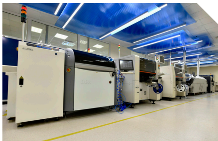
Роботизированные линии чип монтажа: 124 000 комп./час
