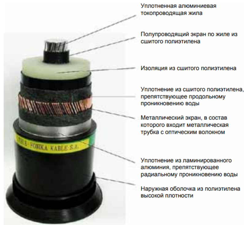
Рисунок 11 – Конструкция силового высоковольтного кабеля с волоконно-оптическим модулем
