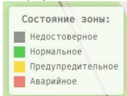
Рисунок 36 – Описание состояния кабельной линии при режиме отображения «Состояние зоны»
