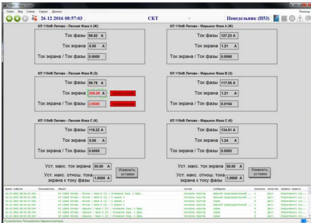
Рисунок 30 – Окно системы контроля токов экрана кабеля
