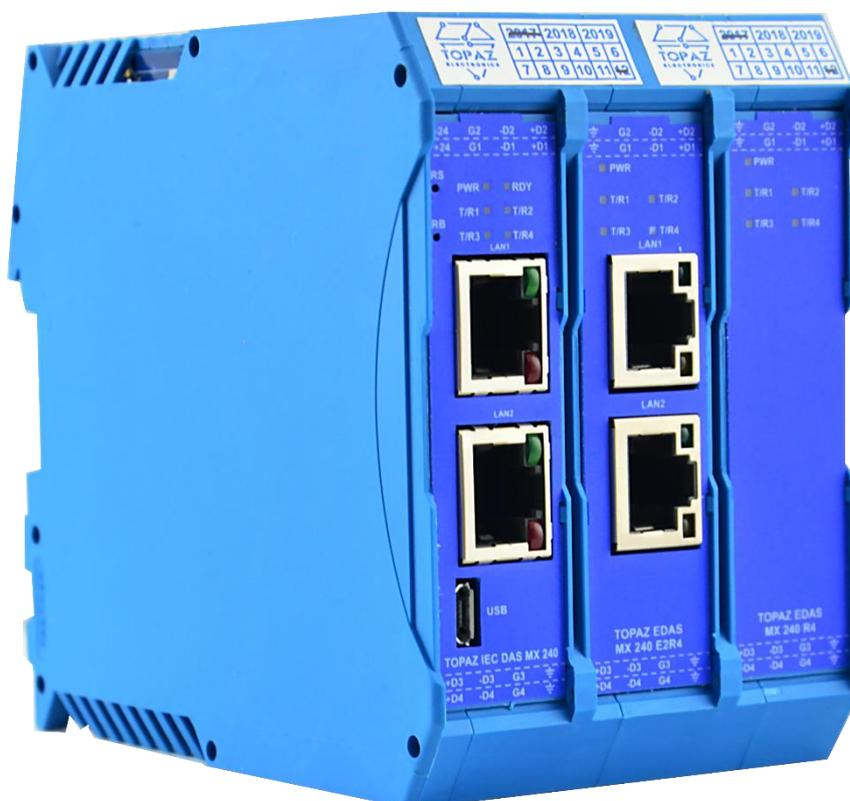
Рисунок А.4 – Внешний вид УСПД TOPAZ IEC DAS MX240-E2Tx1000-E2Tx100-R12-TM
