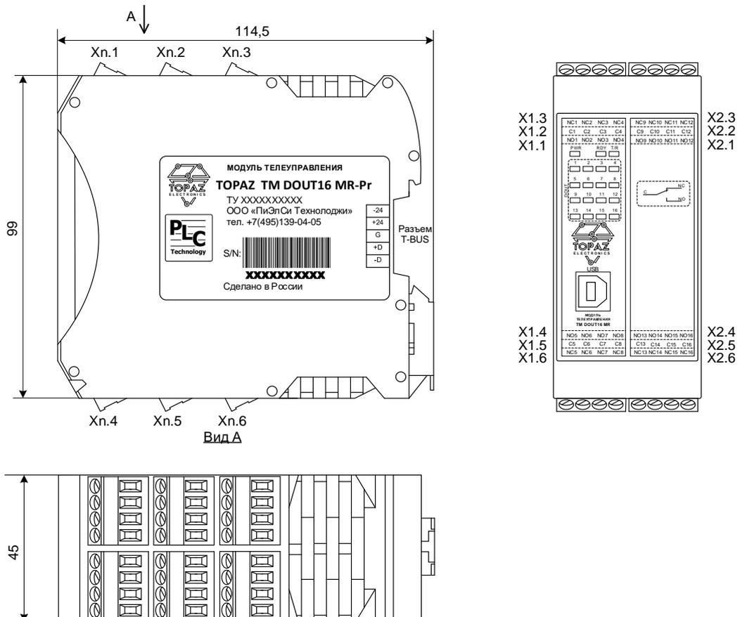
Рисунок А.2 – Габаритные размеры модуля TOPAZ TM DOUT16 MR-Pr
