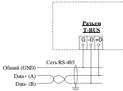
**Рисунок 6 – Схема подключения RS-485**
