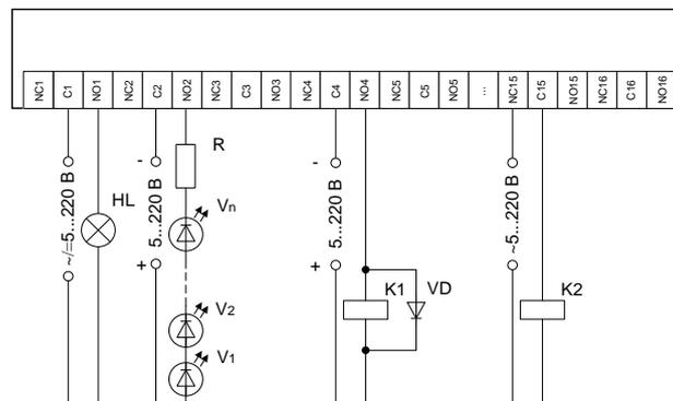
**Рисунок 7 – Варианты подключения различных устройств к модулям DOUT**
