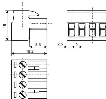
Рисунок 2 – Габаритные размеры разъема MSTBT 2,5/4-ST
