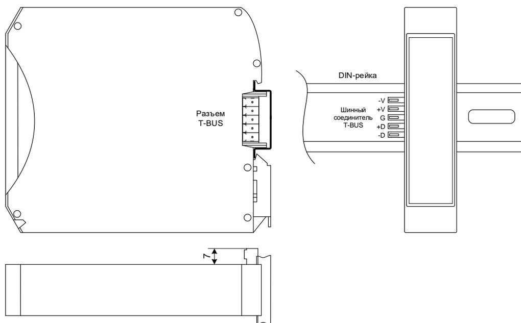
**Рисунок 3 – Размещение модуля на DIN-рейке с шиной T-BUS**
