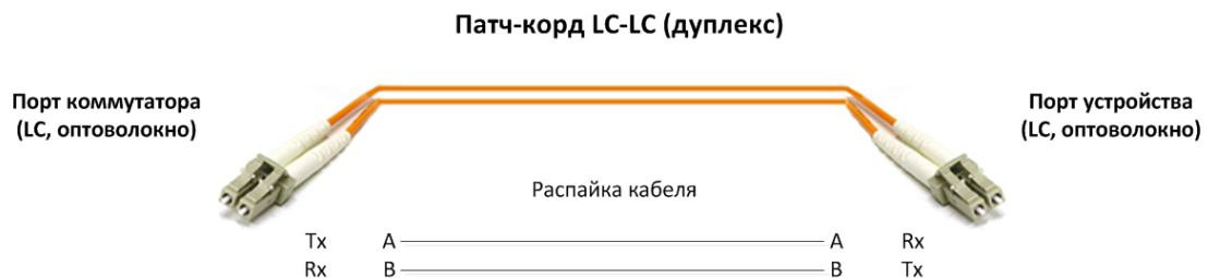
Рисунок 25 – Схема подключения оптоволоконного кабеля
