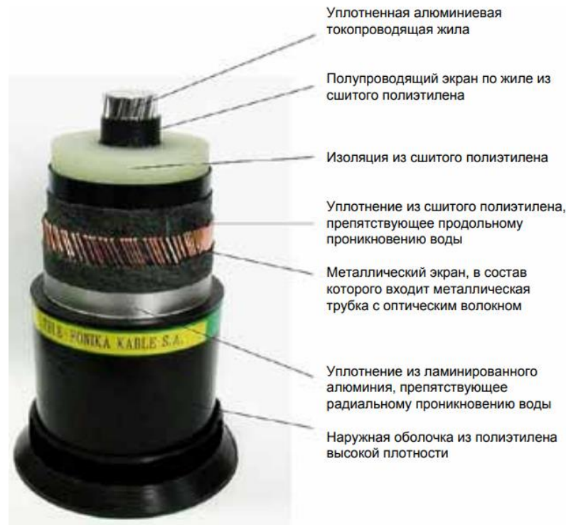
Рисунок 8. Конструкция силового высоковольтного кабеля с волоконно-оптическим модулем
