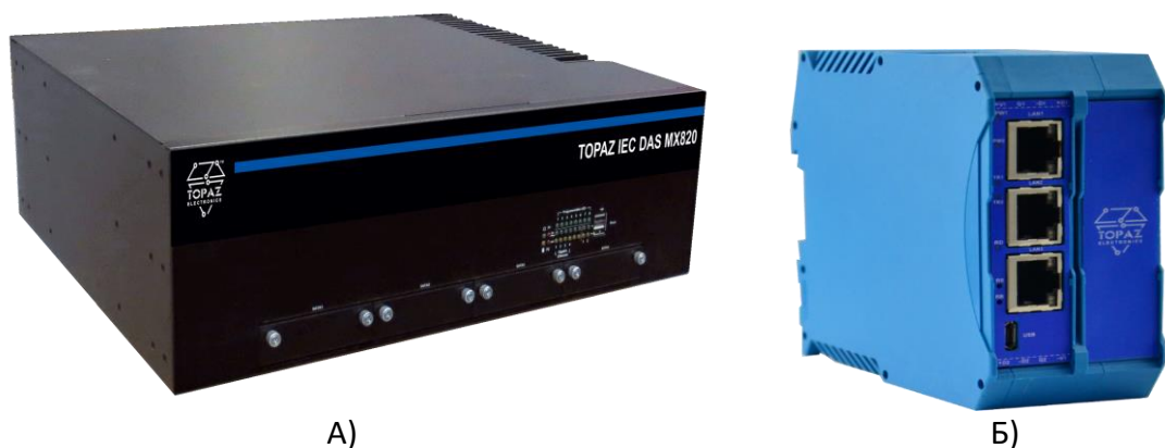
Рисунок 3 – Внешний вид А) УЭИ TOPAZ iSAS MX820; Б) УЭИ TOPAZ iSAS MX681
