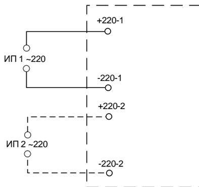
**Рисунок 20 – Схема подключения питания каналов 220В**
