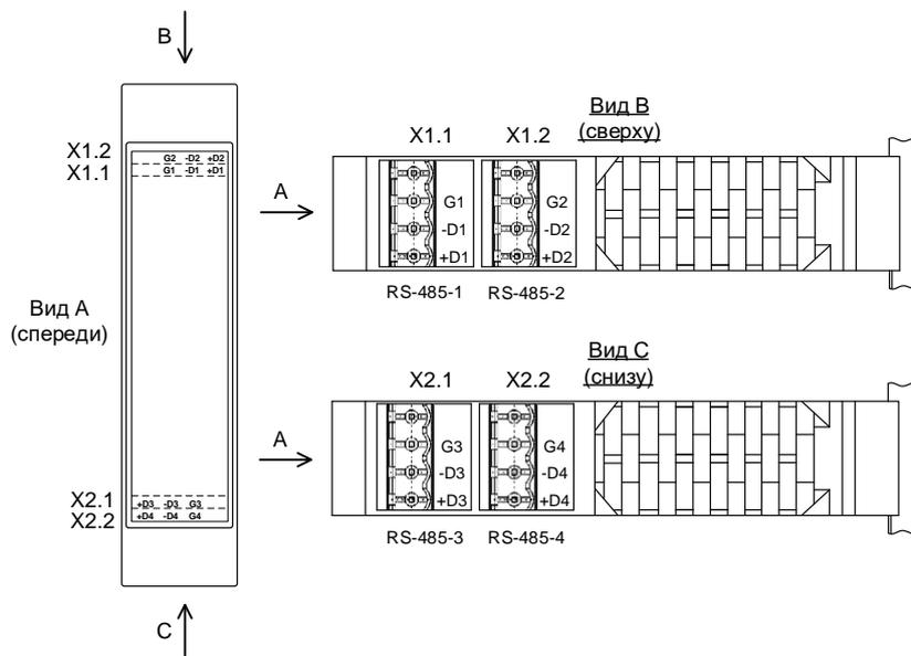
Рисунок 22 – Назначение контактов клеммных блоков RS-485
