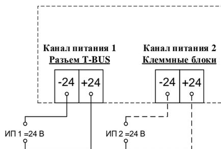
Рисунок 19 – Схема подключения питания каналов 24В
