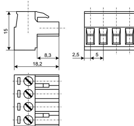
Рисунок 16 – Габаритные размеры разъема MSTBT 2,5/4-ST
