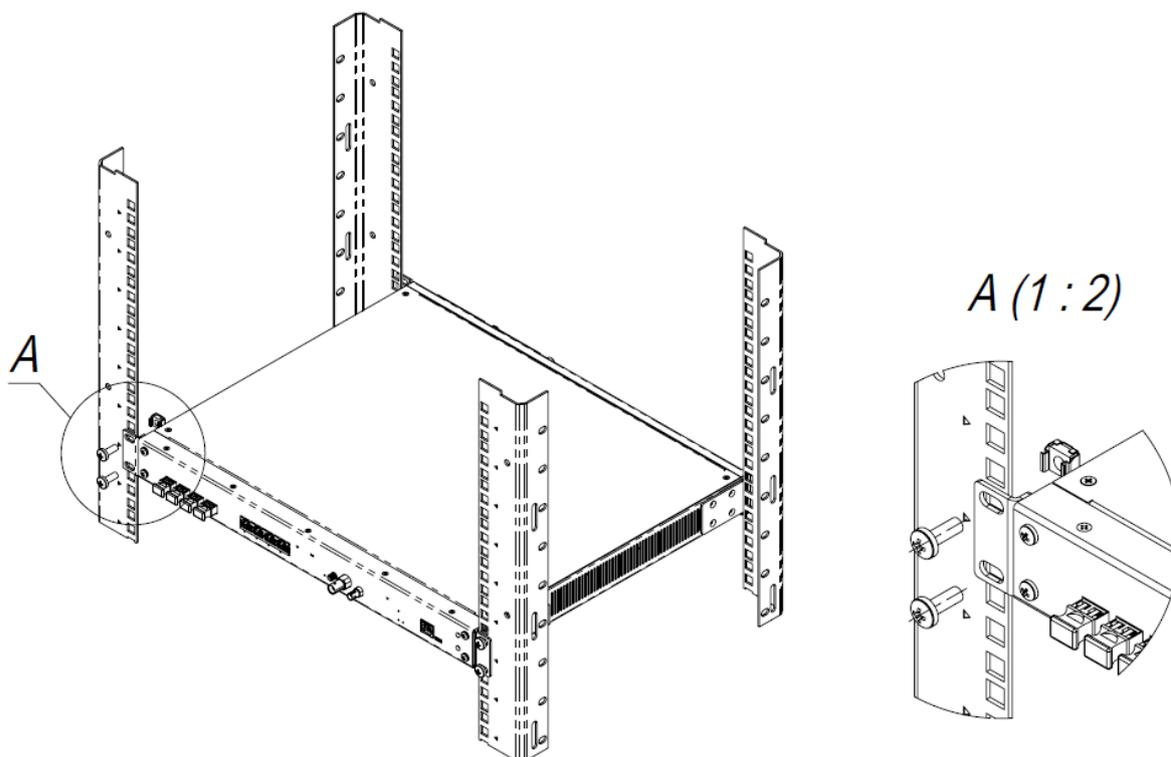
Рисунок 24 – Размещение устройства в стойке 19"
