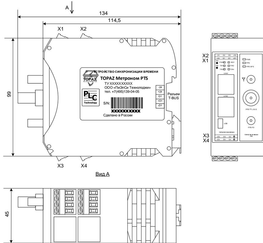
Рисунок В.4 – Габаритные размеры TOPAZ Metroном PTS-2GTx-4R-TTL-FO-2LV-Pr
