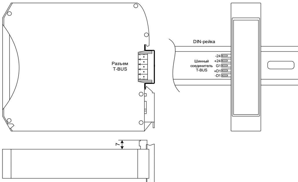
Рисунок 17 – Размещение устройства на DIN-рейке с шиной T-BUS
