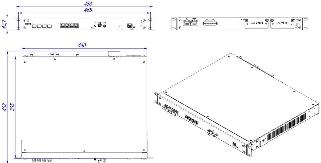
Рисунок В.5 – Внешний вид и габаритные размеры TOPAZ Metroном PTS-1GTx-4Tx-4FxM-TTL-FO-2HV (MR-DGN)
