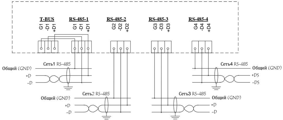
Рисунок 21 – Схема подключения устройства к сетям RS-485
