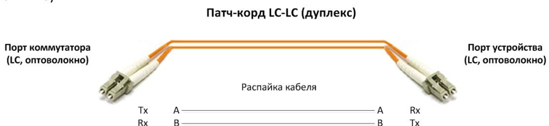
**Рисунок 33 – Схема подключения оптоволоконного кабеля**
