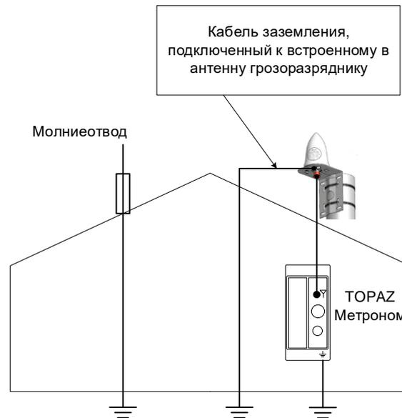
**Рисунок 37 – Схема заземления устройства**
