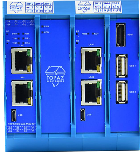
Рисунок В.6 – Внешний вид устройства TOPAZ IEC DAS MX240 E4R4 SSD32/HM17 (4GTx-4R)
