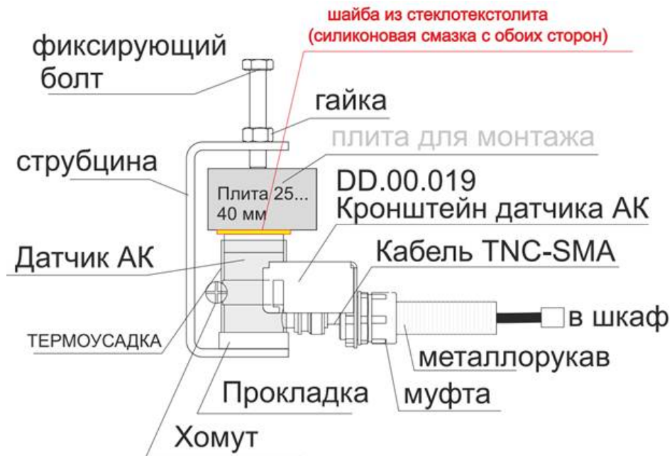
Рисунок 9 – Схема акустического датчика
