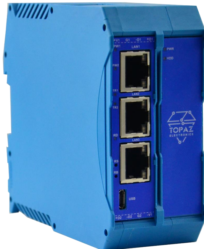
Рисунок А.44 – Внешний вид контроллера TOPAZ IEC DAS MX681 E3R2 (3GTx-2R)
