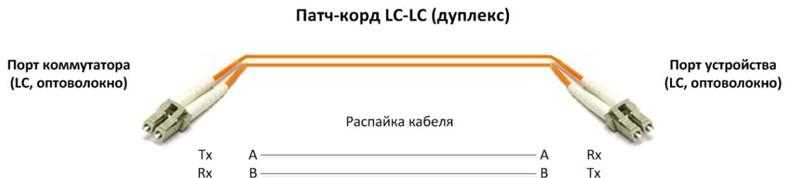
**Рисунок 22 – Схема подключения оптоволоконного кабеля**
