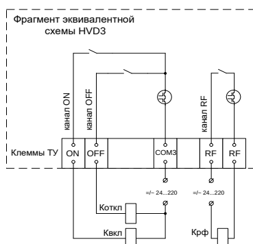
Рисунок 31 – Схема подключения цепей управления модификации RTU7 V2
