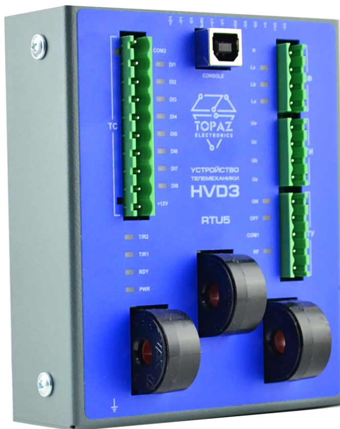
Рисунок А.5 – Внешний вид устройства TOPAZ (ITDS) HVD3-RTU5
