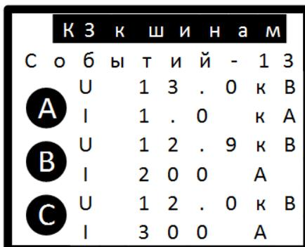
Рисунок 3 – Отображение тревоги K3 на главном экране модуля
