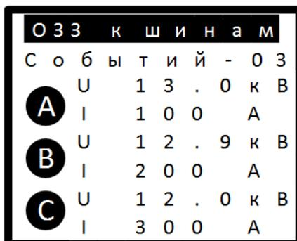
Рисунок 2 – Отображение тревоги O33 на главном экране модуля
