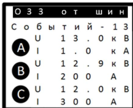
Рисунок 4 – Отображение тревоги O33 на главном экране модуля в ненаправленном режиме
