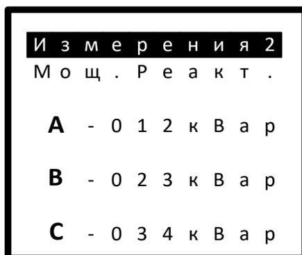
Рисунок 8 – Отображение экрана измерения реактивной мощности
