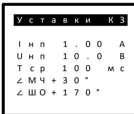
Рисунок 16 – Отображение экрана уставок КЗ
