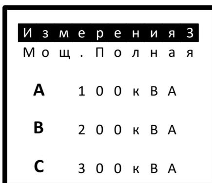
Рисунок 9 – Отображение экрана измерения полной мощности
