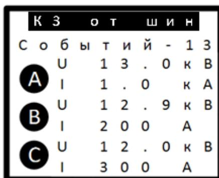
Рисунок 5 – Отображение тревоги КЗ на главном экране модуля в ненаправленном режиме
