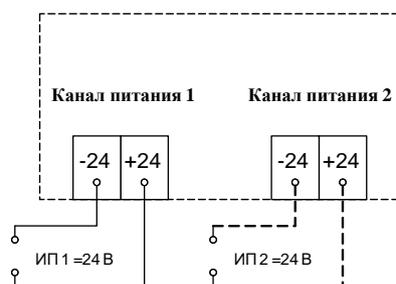
**Рисунок 7 – Схема подключения питания каналов 24В**
