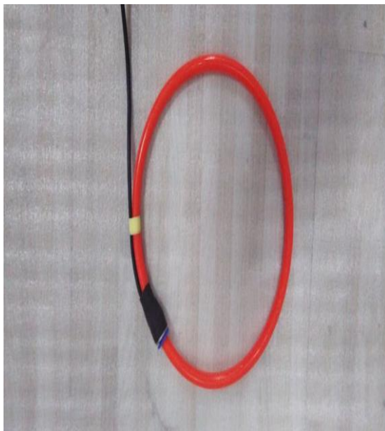
Рисунок 12 – Внешний вид датчика Роговского
