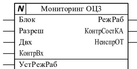
Рисунок 2.7.14 – Логическая схема работы блокировки МОЦ/SOCC
