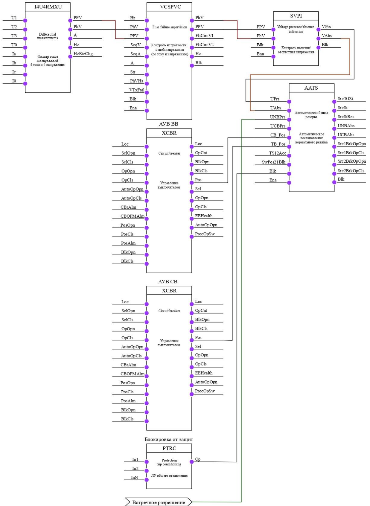
Рисунок 54 – Конфигурация АВР
