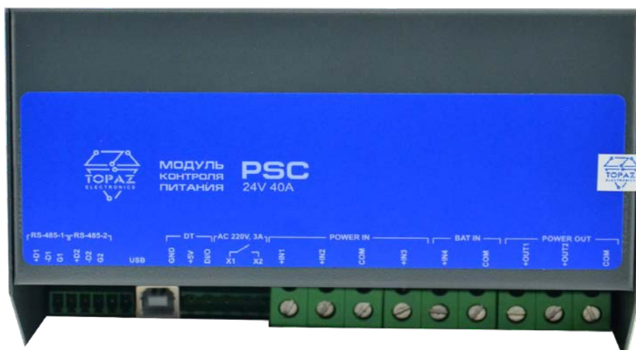
Рисунок 7. Внешний вид устройства TOPAZ PSC
