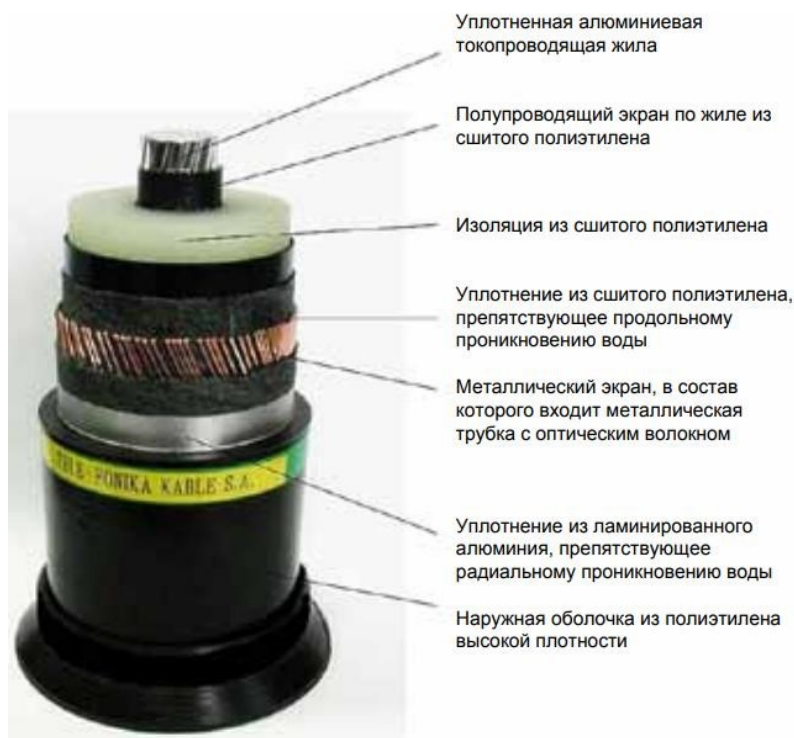
Рисунок 13 – Конструкция силового высоковольтного кабеля с волоконно-оптическим модулем
