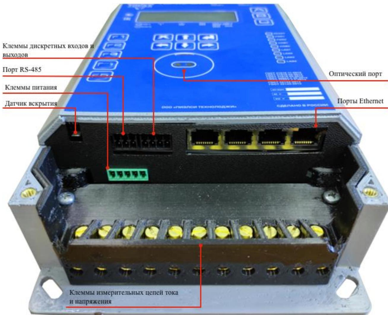
**Рисунок 3 – Расположение и внешний вид разъемов**
