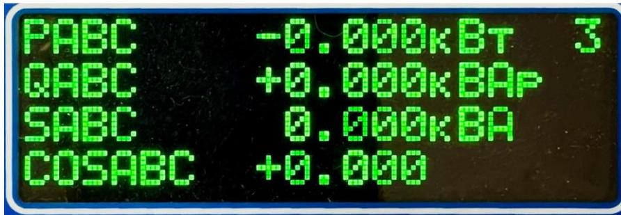
Рисунок 9 – Отображение трехфазных измерений
