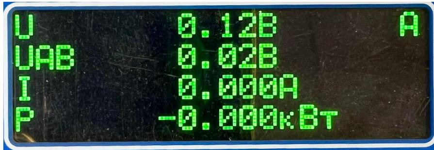
Рисунок 8 – Отображение фазных измерений
