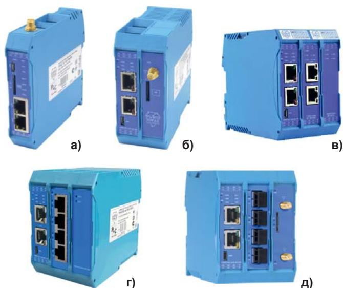
Рис. 1. УСПД ТОРАЗ, снабженное: а) 2 портами Ethernet и 2 портами RS-485 и укомплектованное GSM-модемом на 2 SIM-карты; б) 2 портами Ethernet и 4 портами RS-485 и укомплектованное GSM-модемом на 2 SIM-карты; в) 4 портами Ethernet и 12 портами RS-485; г) 6 портами Ethernet и 4 портами RS-485 и укомплектованное SSD-диск; д) 2 портами Ethernet, 4 оптическими портами и 4 портами RS-485 и укомплектованное GSM-модемом на 2 SIM-карты, со встроенным приемником сигналов точного времени ГЛОНАСС/GPS
