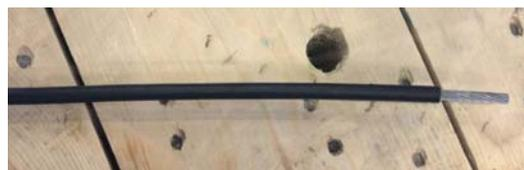
Рис. 9. Чувствительный элемент TOPAZ
