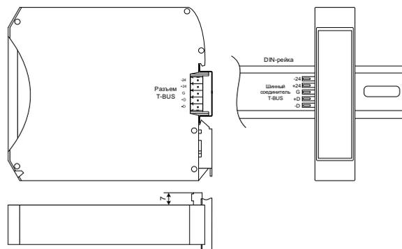
**Рисунок 3 – Размещение устройства на DIN-рейке с шиной T-BUS**
