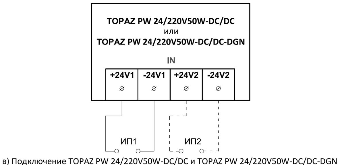
**Рисунок 5 – Схемы подключения питания через клеммный блок**
