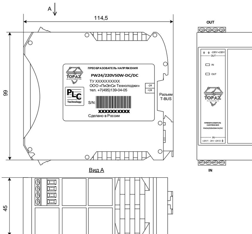
**Рисунок Б.3 – Габаритные размеры преобразователей TOPAZ PW**
