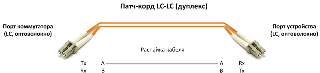
Рисунок 9 – Схема подключения оптоволоконного кабеля
